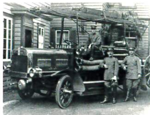
日本初のガソリンポンプ消防自動車 「メリーウェザー号」大正期 横浜開港資料館蔵
