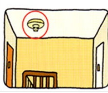
寝室がある階の 階段
